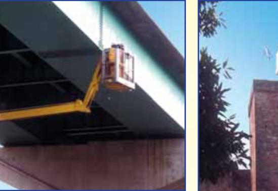
■ Il cestello può venire utilizzato per l'ispezione di pile di ponti e viadotti e di scarpe poste a lato della strada, grazie alla notevole escursione in profondità del braccio al di sotto del piano viario che risulta compresa, a seconda del modello, tra i 10 ed i 25,5 m.
