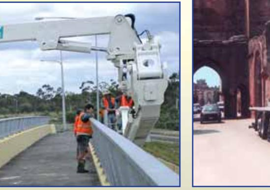
■ Lo sbraccio orizzontale del cestello sottoponte varia, a seconda del modello, dai 5 ai 22 m.
